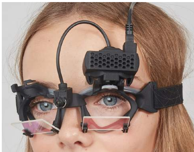
Figure 3.3.1-1 Monture vHIT et joint sphérique pour la caméra. Le laser d'étalonnage est placé au centre de la monture.
