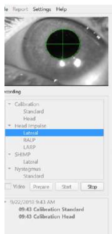
Abbildung 4.4.9-1 Die Funktionen „Prepare“ (Vorbereiten), „Start“ (Starten) und „Stop“ (Stopp) von Tests
