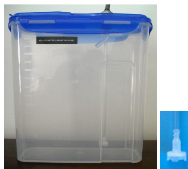
Figura 4 Serbatoio esterno con filtro di raccolta
