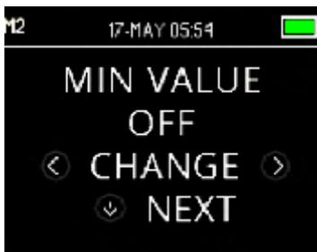
L'impostazione Minimum (Amplitude) Value (Valore minimo [Ampiezza]) consente all'utente di impostare l'unità in modo da includere i valori minimi di ampiezza nel criterio di superamento/non superamento. OtoRead™ è impostato con questa funzione abilitata quando viene spedito dalla fabbrica.
