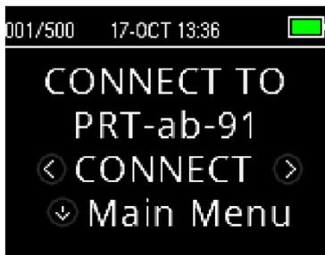
Seguire le istruzioni fornite con la stampante e assicurarsi che questa sia pronta per la comunicazione o la stampa. Dal Main Menu (Menu principale) dello strumento OtoRead™, premere il tasto **^SU** per accedere alla schermata di connessione del dispositivo. Premere il tasto **<SINISTRA** o **>DESTRA** per effettuare la connessione.
