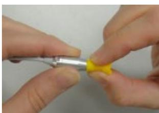
Per sostituire il tubicino della sonda, utilizzare il tappino per afferrare il tubicino stesso e tirarlo via dal corpo della sonda. Smaltire il tubicino della sonda immediatamente per evitare di confondere i tubicini usati con quelli nuovi.
