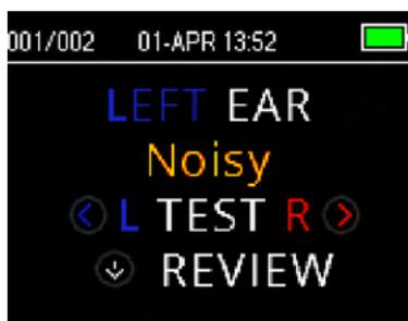
Quando il risultato del test è NOISY (RUMORE), NO SEAL (SIGILLO ASSENTE) o FIT ERR (ERRORE DI ADERENZA), l'esaminatore deve riposizionare la sonda, selezionare un tappino diverso (se necessario) e ripetere il test.
