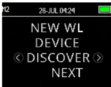
Il menu di accoppiamento di OtoRead™ permette all'utente di accoppiare l'unità OtoRead™ con un dispositivo wireless come una stampante termica o un computer per la stampa dei risultati del test e il trasferimento dei dati.
