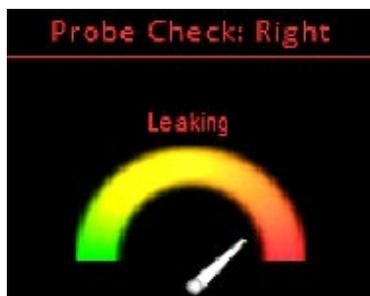
**Leaking (Perdita):** La lancetta punta sul lato destro (arancione) dell'indicatore.
