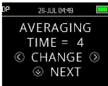
Averaging Time (Tempo medio) si riferisce al tempo di test per frequenza DP. Averaging Time (Tempo medio) ha un impatto importante sul tempo necessario all'esecuzione del test e sul rapporto segnale/rumore (SNR). Una media di due secondi per sei frequenze determina un test circa ogni diciotto secondi.
