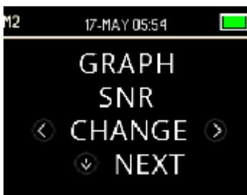
Il menu Graph Style (Stile del grafico) consente agli utenti di selezionare fra due opzioni per la visualizzazione dei risultati. La visualizzazione del grafico SNR mostra il rapporto del segnale per ciascuna frequenza di test DP o banda di test TE. La visualizzazione del grafico dei valori mostra l'OAE assoluta e i livelli di rumore per ciascuna frequenza di test DP o banda di test TE.
