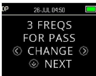
Il numero di frequenze richiesto per determinare un risultato di PASS (SUPERATO) può essere impostato da 0 a 12. Se l'impostazione è su 0, allora non verrà effettuata alcuna valutazione PASS (SUPERATO)/REFER (NON SUPERATO). Questa impostazione viene utilizzata in associazione a PASS SNR (SNR DI SUPERAMENTO) e ai criteri MIN LEVEL (LIVELLO MIN) per determinare il risultato complessivo del test (PASS [SUPERATO] o REFER [NON SUPERATO]).
