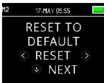
Il menu Reset to Default (Reset delle impostazioni predefinite) permette di ripristinare tutte le impostazioni dello strumento e dei protocolli sulle impostazioni di fabbrica originali.
