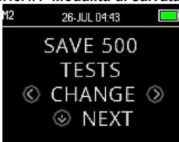
OtoRead™ salva automaticamente solo il risultato del test più recente per ciascun orecchio, ma può conservare 500 test individuali. Premere i tasti **<CHANGE (MODIFICA)>** per modificare l'impostazione su SAVE 500 TESTS (SALVA 500 TEST). Una volta effettuata la selezione, premere **▼NEXT (AVANTI)**.
