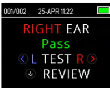
Quando il test è completo, la spia verde READY (PRONTO) si illumina e lo schermo mostra l'orecchio del test e il risultato del test (per i test di screening).
