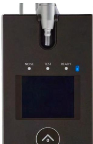
L'indicatore della batteria offre una segnalazione visiva (blu) della funzione di ricarica della batteria e dello stato della stessa durante il funzionamento.
