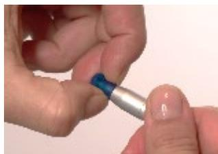
Afferrare il tappino dalla base con le dita e ruotarlo mentre lo si tira via dal tubicino della sonda. Se si afferra la base del tappino, si elimina il rischio che il tubicino della sonda venga rimosso in maniera involontaria dalla testa della sonda assieme al tappino
