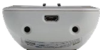
La porta micro-USB sul fondo dello strumento rappresenta il punto di connessione per l'USB utilizzata per la ricarica tramite il cavo USB verso il PC o la rete
