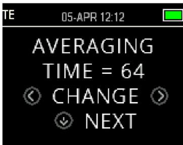
Averaging Time (Tempo medio) per i protocolli TE si riferisce al tempo di test massimo. Averaging Time (Tempo medio) può avere un impatto significativo sull'SNR ottenuto e sul risultato finale del test (ad esempio, PASS [SUPERATO]/REFER [NON SUPERATO]). Il tempo medio dipende dal processo di controllo della sonda.
