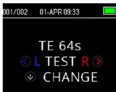
Per avviare il test, inserire la sonda nell'orecchio e selezionare il tasto **SINISTRA** o **DESTRA** per definire l'orecchio da testare.
