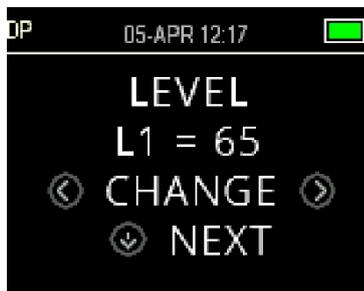
Il Livello L1 si riferisce al livello di stimolo del tono primario f1 (frequenza 1). Il Livello L2 si riferisce al livello di stimolo del tono primario f2 (frequenza 2). L'intensità dei toni primari (L1, L2) può essere modificata su qualsiasi livello fra 40 dB SPL e 70 dB SPL. I livelli di stimolo L1 e L2 possono essere modificati in incrementi da 1 dB premendo i tasti **<CHANGE (MODIFICA)>**.
