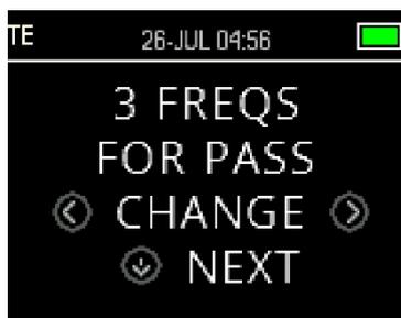
Il numero di frequenze (bande TE) per determinare un risultato di PASS (SUPERATO) può essere impostato da 0 a 6. Se l'impostazione è su 0, allora non verrà effettuata alcuna valutazione PASS (SUPERATO)/REFER (NON SUPERATO). Questa impostazione viene utilizzata in associazione a PASS SNR (SNR DI SUPERAMENTO) e ai criteri MIN LEVEL (LIVELLO MIN) per determinare il risultato complessivo del test (PASS [SUPERATO] o REFER [NON SUPERATO]).
