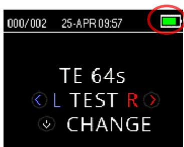
Quando la batteria di OtoRead™ è quasi scarica, la prima indicazione visiva di questa circostanza consiste nel fatto che il simbolo della batteria nell'angolo in alto a destra dello schermo cambia colore.
