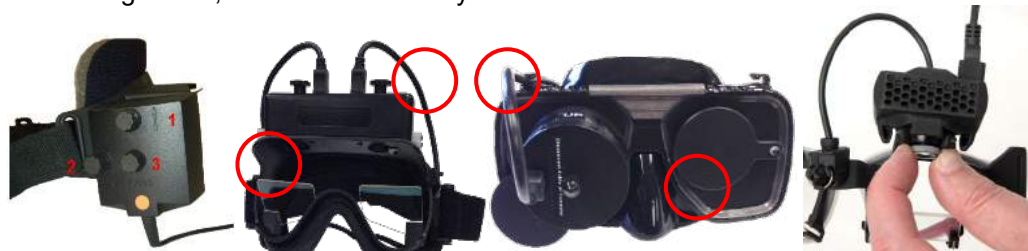
Ábra 3.6-2: Fókusz beállítása a különböző VNG és vHIT szemüvegeken
