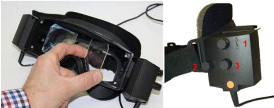
Ábra 2.6-4: Mozgatható IR tükrök az interpupilláris távolságok beállításához (bal) és gombok 1) a függőleges, 2) a vízszintes kamera beállításához, 3) a kamera fókuszához a beállításához (jobb)
