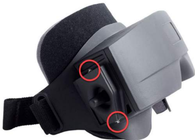
Ábra 2.6-3: Hatszögű rögzítőcsavarok az oldalsó szereléses vizsgáló szemüveg felső és alsó részén, amit a kamera vagy a fedél (l. kép) rögzítéséhez használunk.
