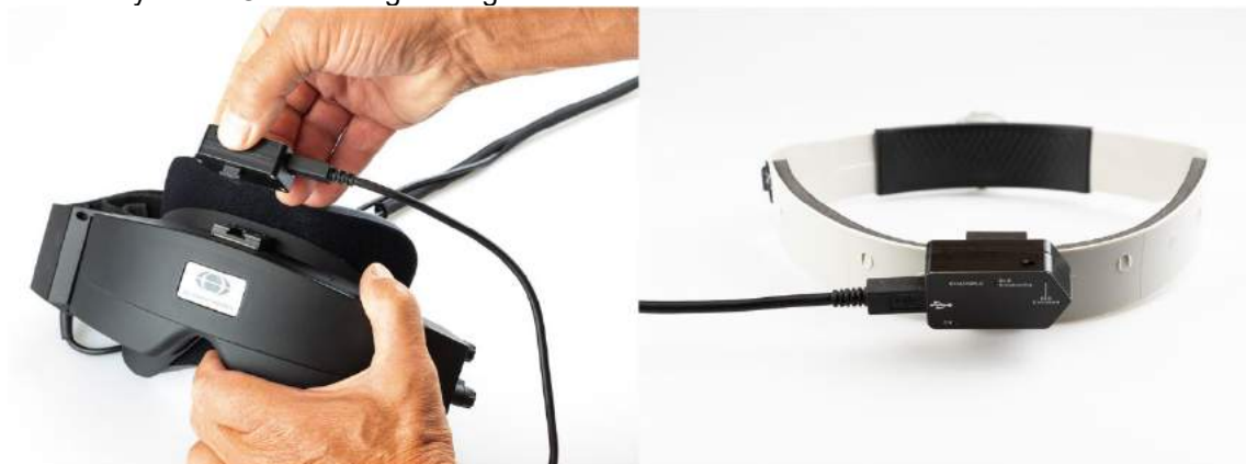
Ábra 2.6-17: VORTEQ™ 2. generációs IMU rögzítése oldal szereléses vizsgáló szemüvegre (bal) és a fejpántra szerelve a Dinamikus Vizuális Élesség (DVA) vizsgálatához (jobb)
