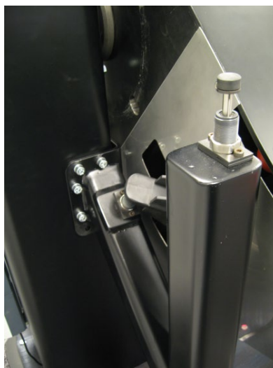
Az ütköző a függőleges ívjárat DPRM során az alsó hidraulikus ütés csillapítónak ütközik.
