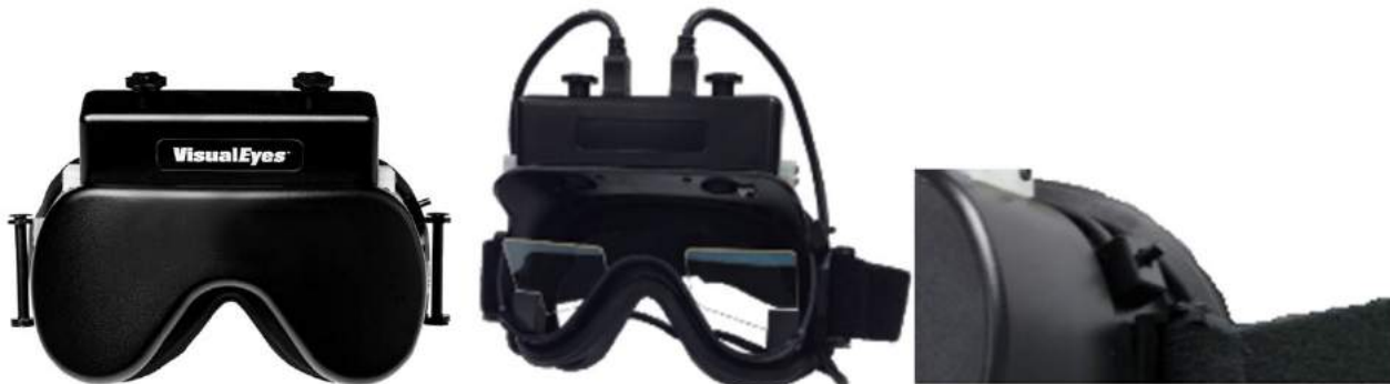
Figure 2.6-5 : Masque à montage sur le dessus avec cache (à gauche), sans cache (au milieu) et interrupteur marche/arrêt sur le masque (à droite)
