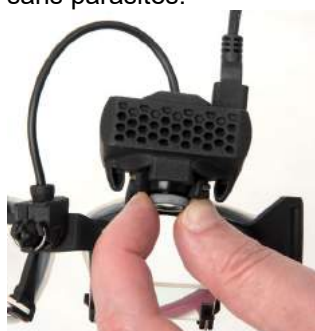
Figure 2.6-8 : Réglage de la mise au point sur le masque EyeSeeCam
