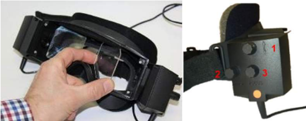
Figure 2.6-4 : Miroirs IR réglables pour l'ajustement à la distance interpupillaire (à gauche) et molettes pour 1) le réglage vertical de la caméra, 2) le réglage horizontal de la caméra, 3) le réglage de la mise au point de la caméra (à droite)
