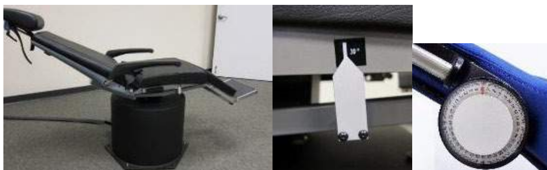
Figure 3.9-3 Fauteuil incliné pour test calorique avec marqueur d'angle calorique et cadran d'inclinaison
