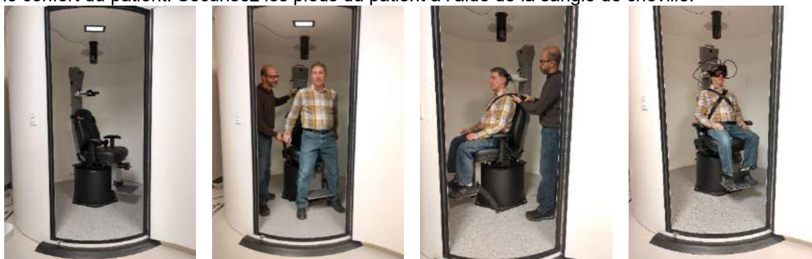
Figure 3.5-3 Images séquentielles de la procédure d'installation du patient dans le fauteuil Orion/System 2000 Auto Traverse et Comprehensive (gauche à droite)
