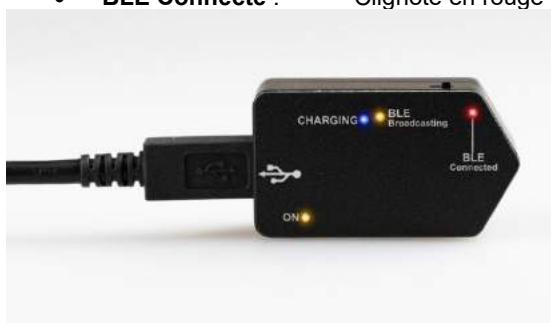
Figure 2.6-18 : 2 ème génération de VORTEQ™ IMU avec les voyants LED allumés
