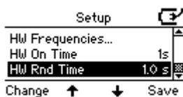
Tryck på Change (Ändra) för att ställa in slumpvis tid. Slumpvis tid kan ställas in på mellan 0 och 1,6 sekunder.
