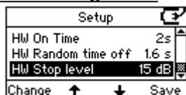
Tryk på Change for at indstille den nedre grænse og bestemme, hvornår du skal gå videre til næste frekvens. Den nedre grænse kan indstilles til mellem -10 og 20 dB.
