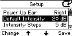
Määritä oletusintensiteetti korvaa vaihdettaessa. Valitse seuraavista: Off (Pois päältä), -10dB, -5dB, 0dB, 5dB, 10dB, 15dB, 20dB, 25dB, 30dB, 35dB, 40dB, 45dB ja 50dB.
