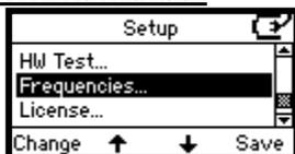
Tryck på Change (Ändra) för att komma till standard frekvensintervall från 125 Hz till 8 kHz för dagligt bruk.
