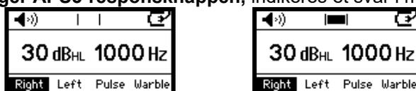
C) **Tænd eller batteristatus:** Strømstatus for AS608 / AS608e vises i øverste højre hjørne af displayheaderen.
