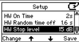
Druk op Change (Wijzigen) om de onderlimiet in te stellen en te bepalen wanneer naar de volgende frequentie moet worden gegaan. De onderlimiet kan worden ingesteld tussen -10 en 20 dB. Druk op Save (Opslaan) om terug te keren naar het configuratiehoofdmenu.
