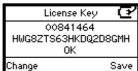
Syötä ja/tai muokkaa AS608/AS608e-laitteen lisenssiavainta painamalla Change (Muuta asetusta).
