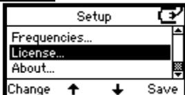
Drücken Sie „Ändern“, um auf den Lizenzschlüssel für das AS608/AS608e zuzugreifen.
