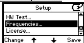
Druk op Change (Wijzigen) om naar het standaard frequentiebereik van 125 Hz tot 8 voor dagelijks gebruik kHz te gaan.
