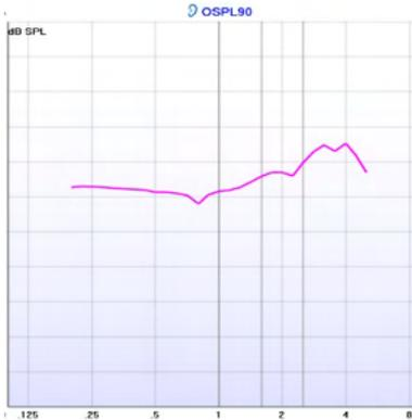
**Le graphique** affiche les courbes HIT mesurées. L'axe horizontal présente la fréquence et l'axe Y montre la sortie ou le gain, selon la mesure effectuée.
