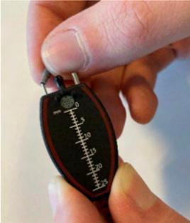
Les tubes de la sonde REM sont à usage unique.
