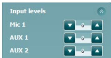
**Input levels** (Niveaux d'entrée) : glissières permettant de régler le niveau d'entrée sur 0 VU pour l'entrée sélectionnée. Ceci permet d'obtenir l'étalonnage correct pour Mic1, AUX1 et AUX2.
