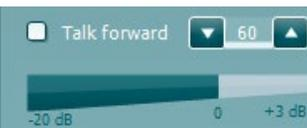
**Talk Forward** (Parole) active le micro Talk Forward. Les flèches peuvent être utilisées pour régler le niveau de parole via les transducteurs actuellement sélectionnés. Le niveau sera précis lorsque le compteur VU indique la valeur zéro dB.
