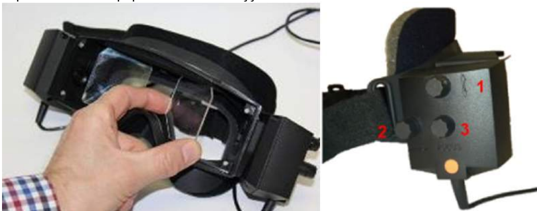
Kuva 2.6-4: Säädettävät IR-peilit pupillien välisen etäisyyden sovittamiseen (vasemmalla) sekä nupit 1) kamerasäätöön, 2) kamerasäätöön ja 3) kamerasäätöön (oikealla)
