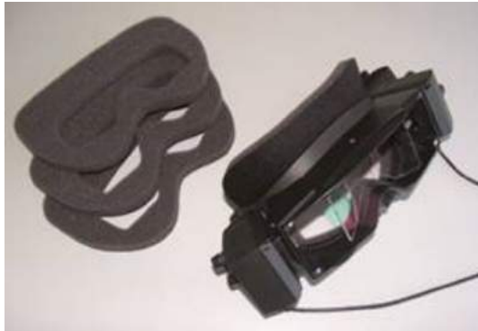
Kuva 2.6-2: Sivukameralliset lasit ja irrotettava suojus (vasemmalla) sekä kertakäyttöisiä vaihtopehmusteita (oikealla)
