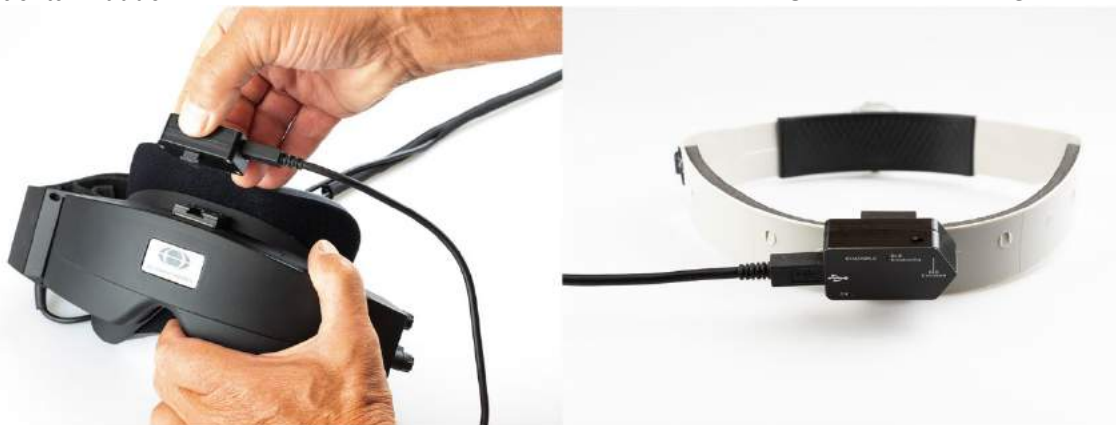
Kuva 2.6-17: 2. sukupolven VORTEQ™ IMU:n kiinnitys sivukamerallisiin laseihin (vasemmalla) ja päähinnaan dynaamista näöntarkkuuden mittausta varten (oikealla)
