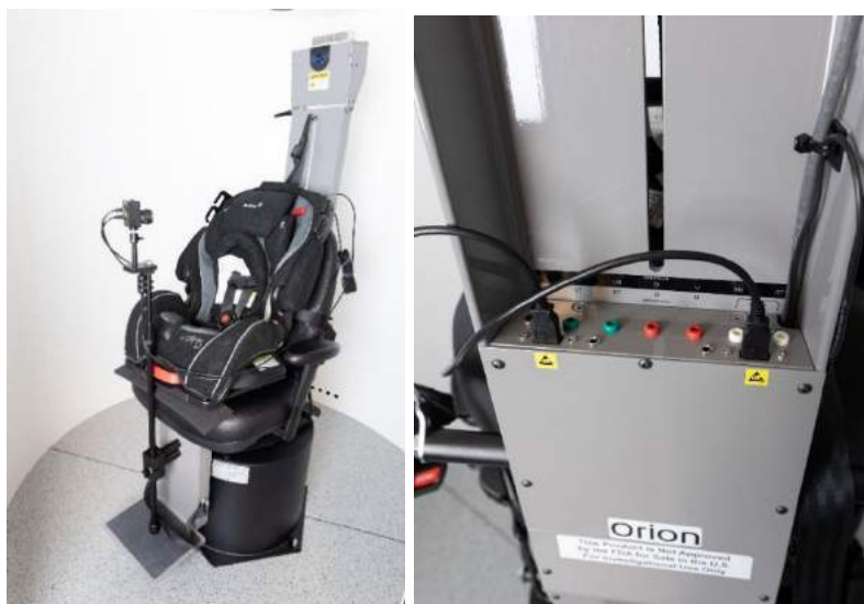
Kuva 2.6-30: PEDIATRINEN SEURANTAKAMERA KIINNITETTYNÄ ORION AUTO-TRaverse/COMPREHENSIVE -TUOLIIN JA KYTKETTYNÄ TUOLIN TAKANA OLEVIIN USB-PORTEIHIN
