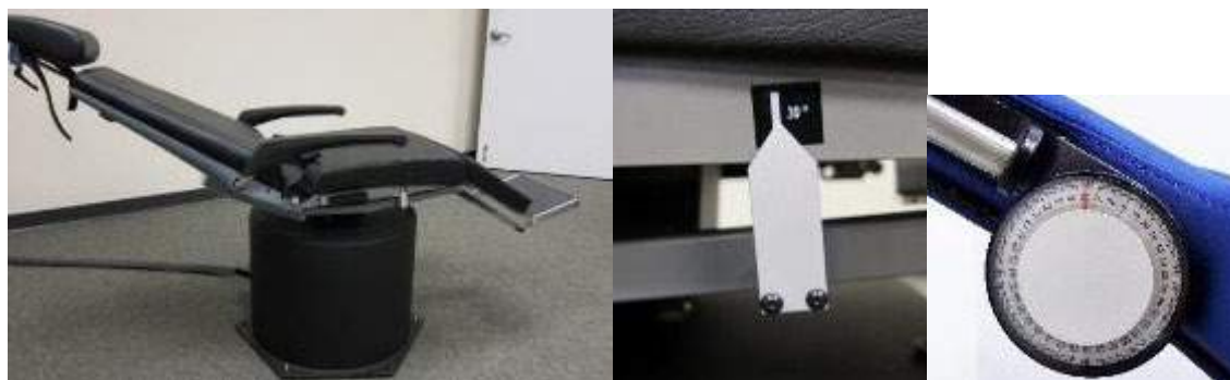
Kuva 3.9-3 Kalorista koetta varten kallistettu tuoli, kulman osoitin ja kallistuspyörä
