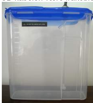
Figur 4 Ekstern tank med innsamlingsfilter
