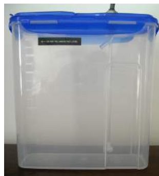
Afbeelding 4 Externe tank met opvangfilter
