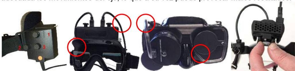
Figura 3.6-2: Ajuste del enfoque en las diferentes gafas VNG y vHIT
