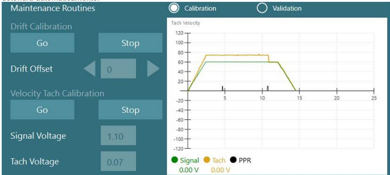
Figura 2.6-37: Calibración de desviación y Calibración tach de velocidad para el tambor optocinético en el sillón con avance automático/integral
