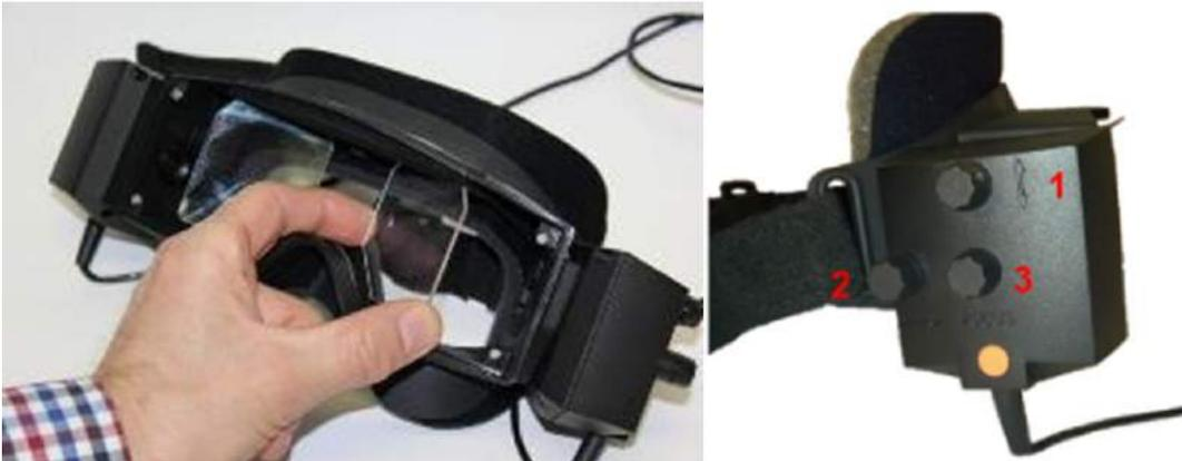
Figura 2.6-4: Espejos IR ajustables para el ajuste de la distancia interpupilar (izquierda), y botones para 1) ajuste vertical de la cámara, 2) ajuste horizontal de la cámara, 3) ajuste del enfoque de la cámara (derecha)
