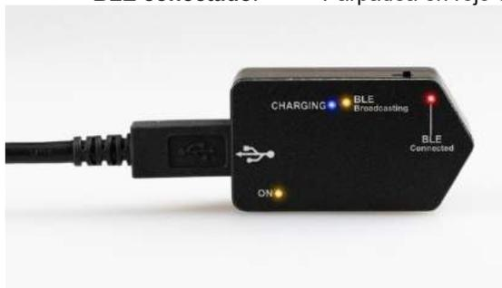
Figura 2.6-18: IMU VORTEQ™ de 2ª generación con LEDs encendidos
