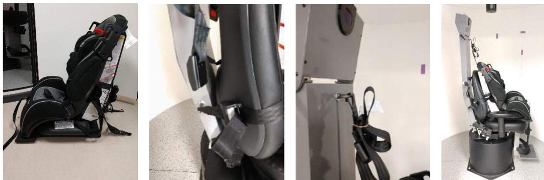
Figura 3.5-4 Imágenes secuenciales de la instalación del asiento infantil sobre el sillón AT/C (izquierda a derecha)
