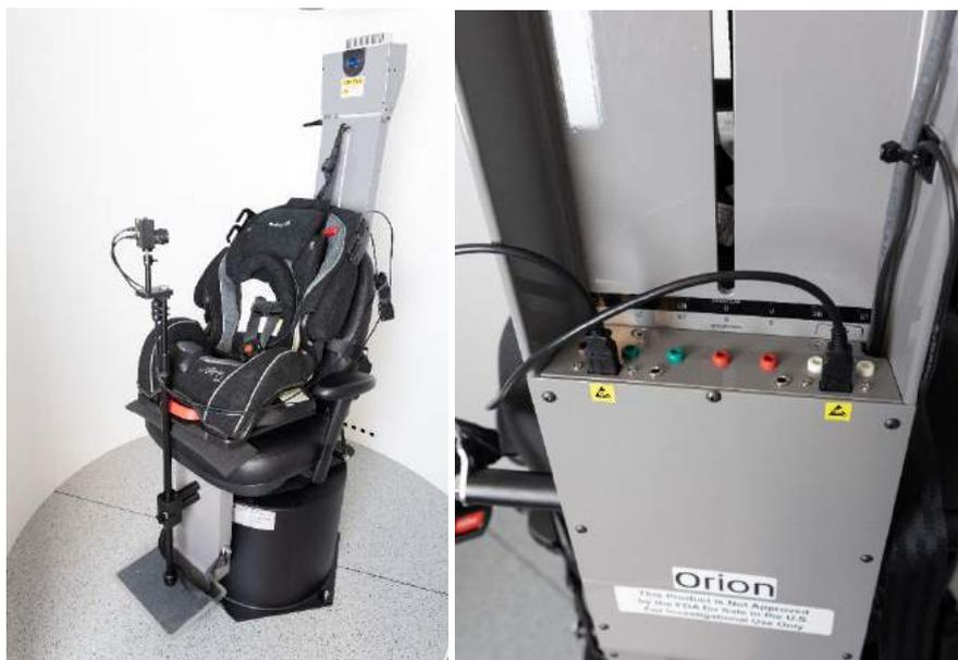
Figura 2.6-30: Cámara de observación pediátrica conectada al sillón Orion con Avance automático/Integral y conectada a los puertos USB en la parte trasera del sillón.
