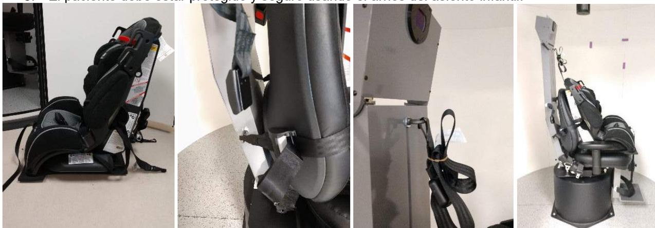
Figura 2.6-29: Imágenes secuenciales de la instalación del asiento infantil sobre el sillón con Avance automático/Integral (izquierda a derecha)
