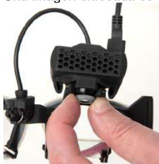
Figura 2.6-8: Ajuste del enfoque en las gafas EyeSeeCam
