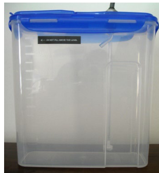
Figura 4 Depósito externo con filtro de recogida
