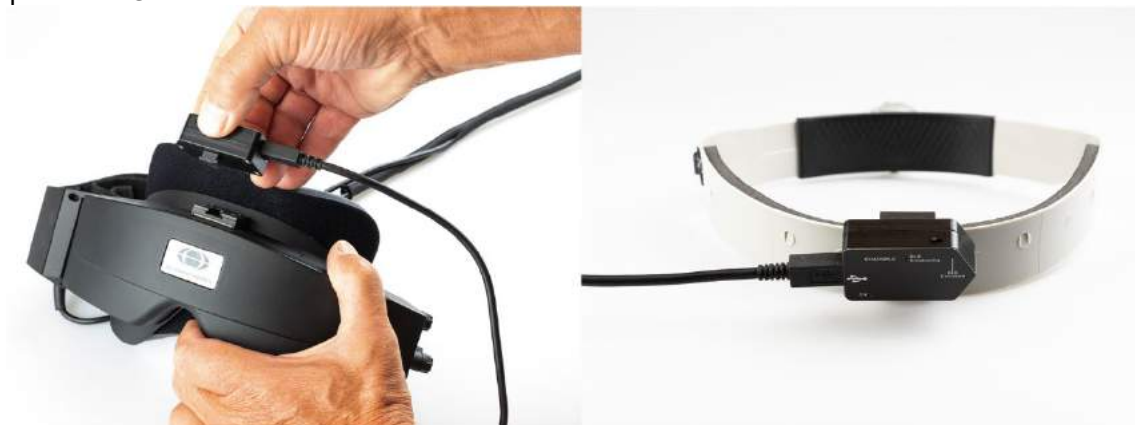
Εικόνα 2.6-17: Το VORTEQ™ IMU 2 ης γενιάς τοποθετείται σε γυαλιά πλάγιας στήριξης (αριστερά) και τοποθετείται στην κορδέλα κεφαλιού για δυναμική οπτική οξύτητα (δεξιά)
