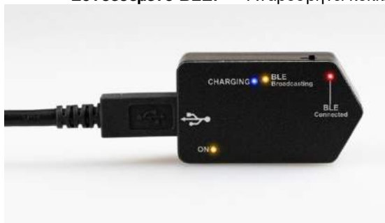
Εικόνα 2.6-18: VORTEQ™ IMU 2 ης γενιάς με ενεργοποιημένα LED
