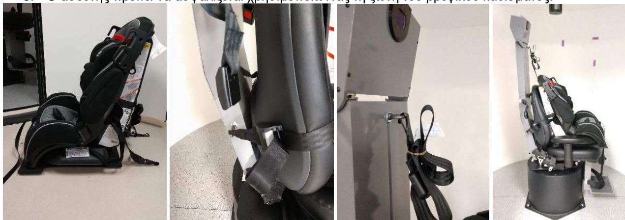
Εικόνα 2.6-29: Διαδοχικές εικόνες τοποθέτησης παιδικού καθίσματος αυτοκινήτου σε καρέκλα Auto-Travel/Comprehensive (από αριστερά προς τα δεξιά)
