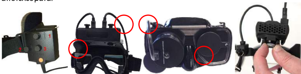
Εικόνα 3.6-2: Προσαρμογή εστίασης στα διαφορετικά γυαλιά VNG και vHIT
