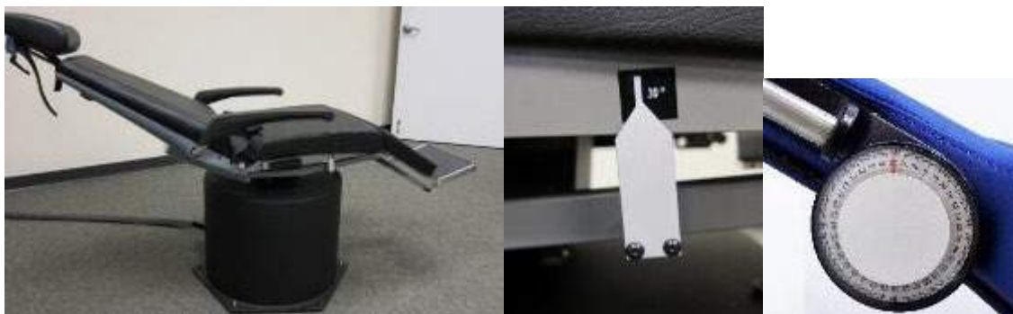
Εικόνα 3.9-3 Ανακλινόμενη καρέκλα για δοκιμή θερμιδικού αντανακλαστικού με δείκτη θερμιδικής γωνίας και καντράν κλίσης
