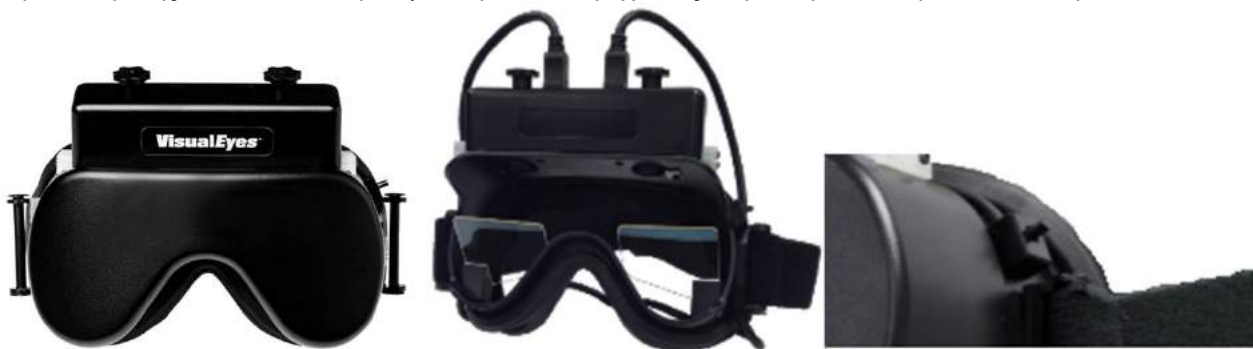
Εικόνα 2.6-5: Γυαλιά επάνω στήριξης με κάλυμμα (αριστερά), χωρίς κάλυμμα (μέση) και διακόπτης start/stop στα γυαλιά (δεξιά)
