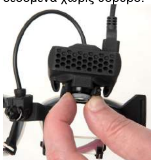
Εικόνα 2.6-8: Ρύθμιση εστίασης στα γυαλιά EyeSeeCam
