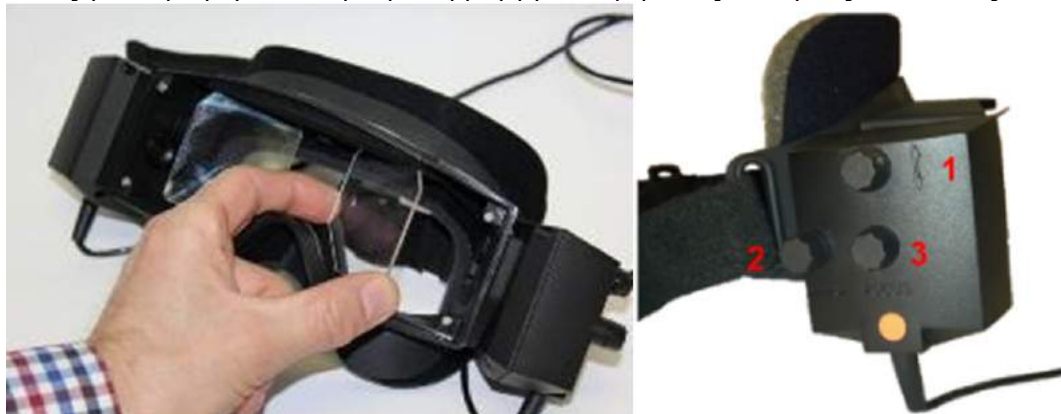
Εικόνα 2.6-4: Ρυθμιζόμενοι καθρέφτες υπερύθρων για ρύθμιση απόστασης μεταξύ της κόρης (αριστερά) και επιλογείς για 1) κάθετη ρύθμιση κάμερας, 2) οριζόντια ρύθμιση κάμερας, 3) ρύθμιση εστίασης κάμερας (δεξιά)
