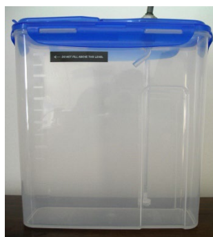
Εικόνα 4 Εξωτερική δεξαμενή με φίλτρο συλλέκτη
