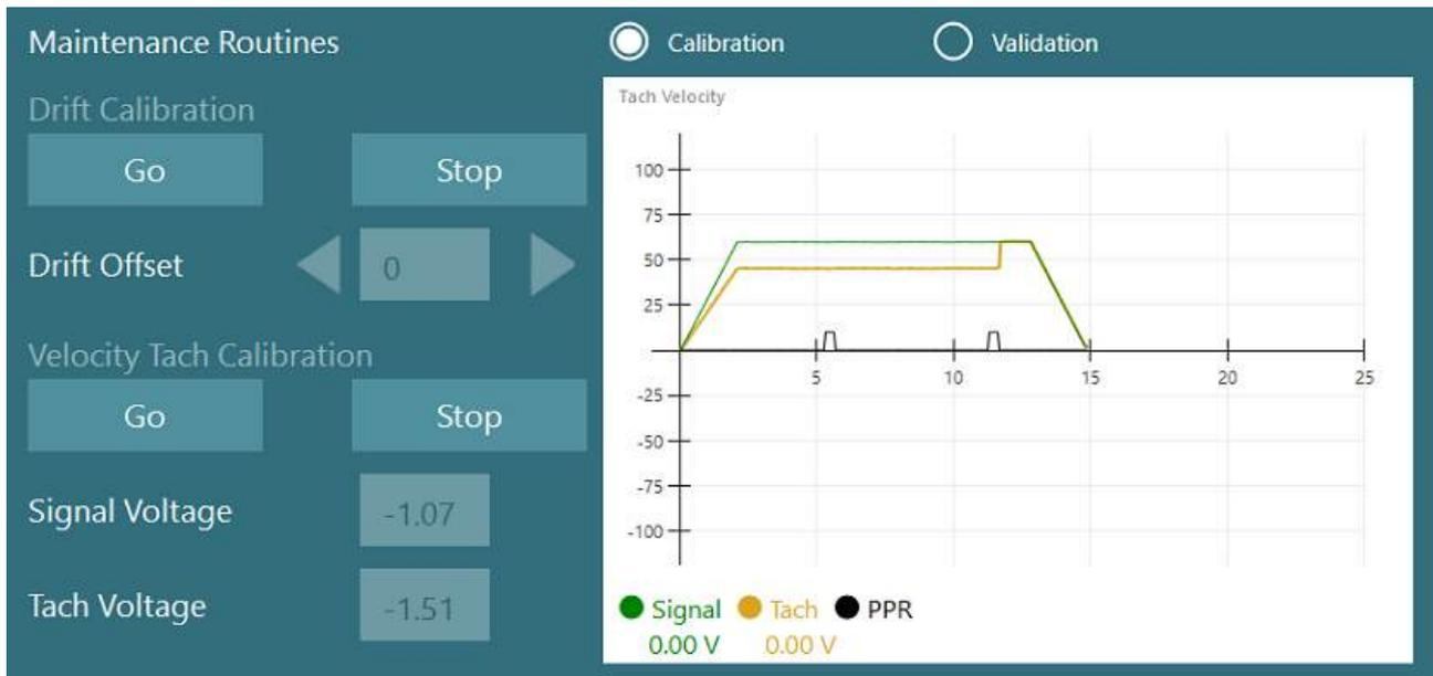
Abbildung 2.6-33: Kalibrierung von Abweichung und Geschwindigkeitsmessung
