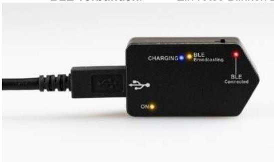
Abbildung 2.6-18: VORTEQ™ IMU-Sensor der 2. Generation mit aktiven LEDs
