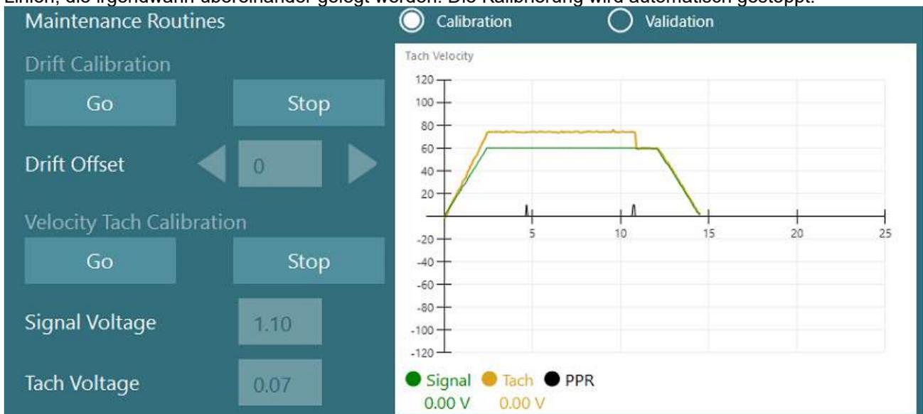
Abbildung 2.6-37: Kalibrierung von Abweichung und Geschwindigkeitsmessung für die optokinetische Trommel an einem Auto-Traversal-/Comprehensive-Stuhl.
