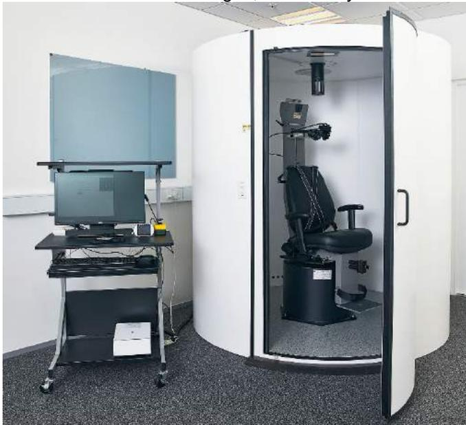
Abbildung 2.6-24: Orion Auto-Traverse-/Comprehensive-Drehstuhl
