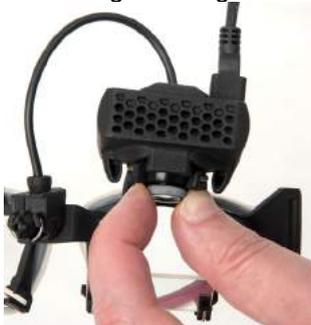
Abbildung 2.6-8: Einstellung der Bildschärfe bei der EyeSeeCam-Brille
