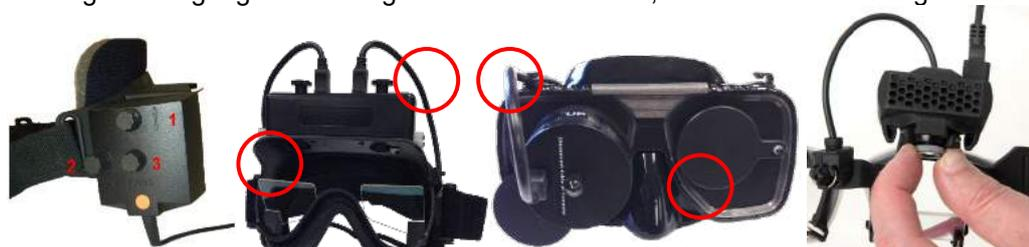
Abbildung 3.6-2: Einstellung der Bildschärfe bei verschiedenen VNG- und vHIT-Brillen
