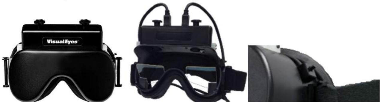
Abbildung 2.6-5: Brille mit an der Oberseite angebrachter Kamera und Abdeckung (links), ohne Abdeckung (Mitte) und Start-/Stoppschalter an der Brille (rechts)
