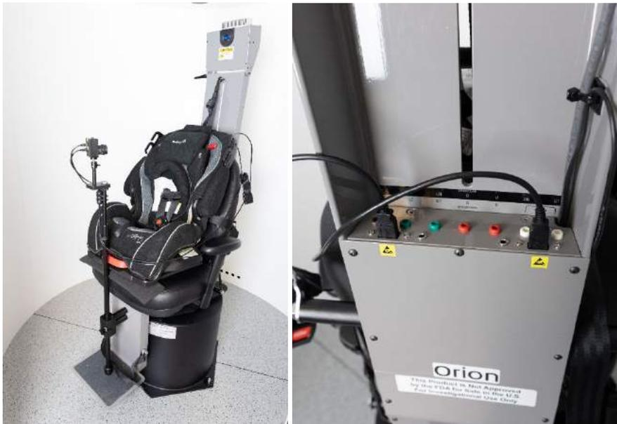
Abbildung 2.6-30: Pädiatrische Beobachtungskamera an einem Orion Auto-Traversal-/Comprehensive-Stuhl, angeschlossen an die USB-Anschlüsse an der Rückseite des Stuhles
