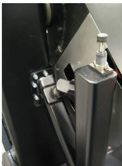
Stoppet vil gå i indgreb med den øvre, hydrauliske støddæmper ved DPRM.
