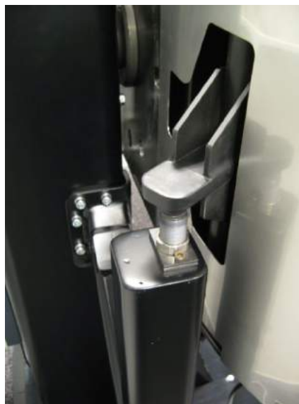
Stop aktiverer den øvre hydrauliske støddæmper ved horisontal kanal DPRM.
