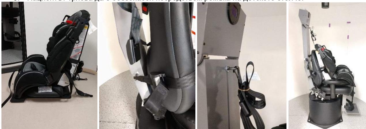
Фигура 2.6-29: Изображения в последователност за напасване на детско столче за автомобил в стол Auto-Traverse/ Comprehensive (отляво надясно)
