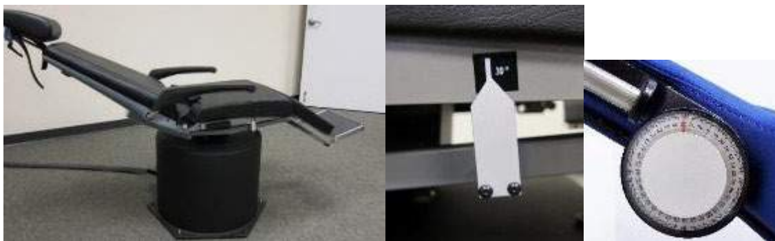
Фигура 3.9-3 Лягащ стол за калорично тестване с маркировка за калоричния ъгъл и циферблат за наклона
