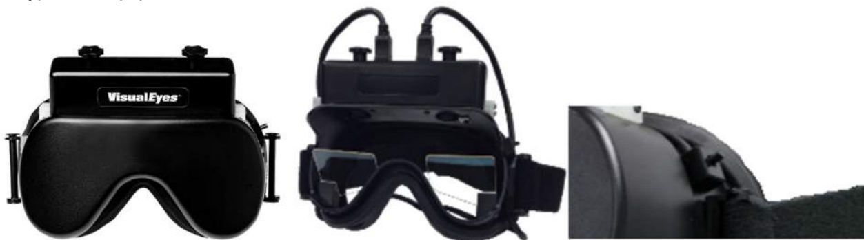
Фигура 2.6-5: Очила с горно монтиране с капак (вляво), без капак (в средата), и превключвател за пускане/спиране на очилата (вдясно)
