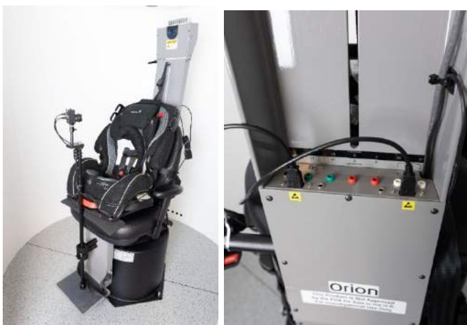
Фигура 2.6-30: Педиатрична камера за наблюдение, прикрепена към стол Orion Auto-Traversal/Comprehensive и свързана към USB портовете на гърба на стола
