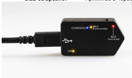
Фигура 2.6-18: VORTEQ™ IMU 2-ро поколение с включен светодиод
