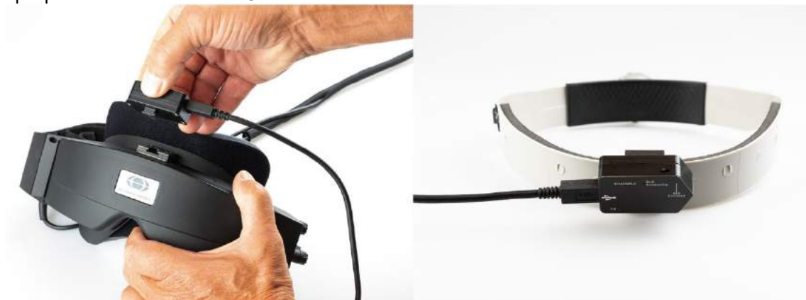
Фигура 2.6-17: VORTEQ™ IMU 2-ро поколение се монтира на очила със странично монтиране (ляво), и на лента за глава за динамична зрителна острота (дясно)
