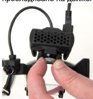
Фигура 2.6-8: Регулиране на фокуса на очилата EyeSeeCam
