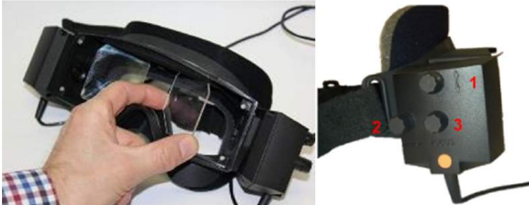
Фигура 2.6-4: Регулируеми инфрачервени огледала за регулиране на междузенично разстояние, и копчета за 1) вертикално регулиране на камера; 2) хоризонтално регулиране на камера; 3) регулиране фокуса на камерата (дясно)
