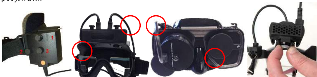
Фигура 3.6-2: Настройване на фокуса върху различните VNG и vHIT очила
