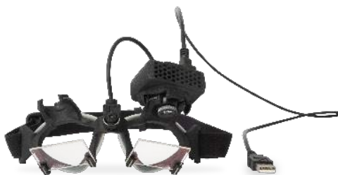
Фигура 2.6-7: Очила EyeSeeCam
