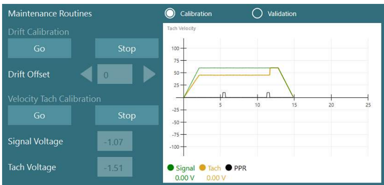
Фигура 2.6-33: Калибриране на тахометри за изместване и скорост
