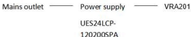
Fig. 1. VRA201 utilisé avec l'alimentation électrique homologuée pour un usage médical.
