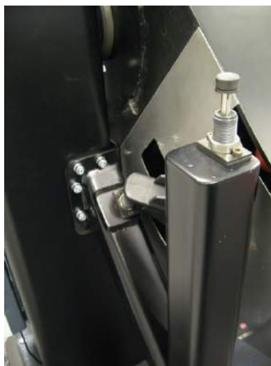
La parada conectará con el amortiguador de impactos hidráulico inferior durante la DPRM del canal vertical.
