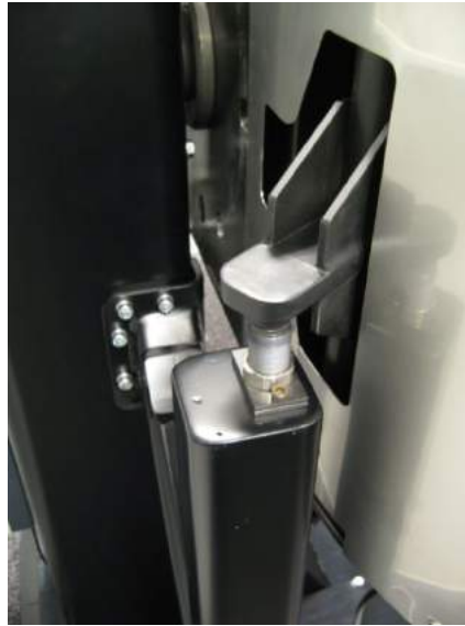
Der Anschlag liegt beim DPRM des horizontalen Bogengangs am oberen hydraulischen Stoßdämpfer an.
