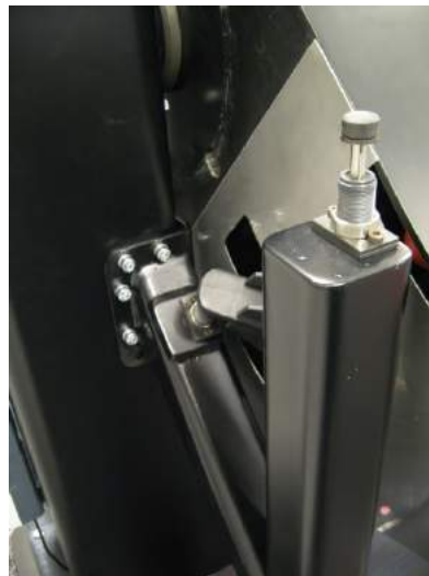
Der Anschlag liegt beim DPRM des vertikalen Bogengangs am unteren hydraulischen Stoßdämpfer an.
